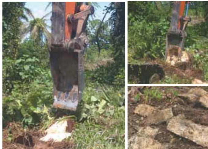
Figura 30. Modificaciones de la pala de la excavadora para la destrucción de estípites de palmas. (Palmeras Salamanca y Araki; foto de R. Aldana).
