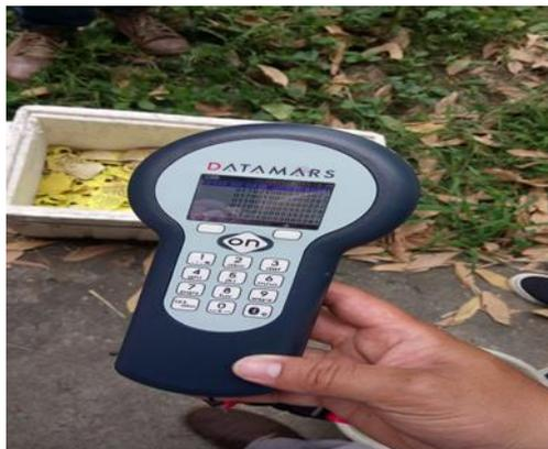
**Lectura mediante lector de radiofrecuencia DATAMARS**
