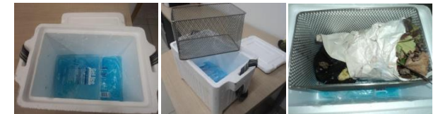
Figura 7. Adecuación de la nevera de icopor para transporte y envío de muestras.
