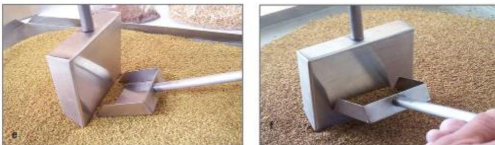
**Figura 13.** Presentación secuencial a, b, c, d, e, f, en la obtención de una muestra por el método de la cuchara. ISTA, 2022.
