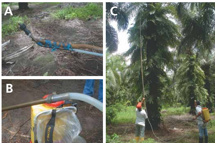
Figura 41. Bomba de espalda modificada para la aplicación de insecticidas al cogollo. A. Manguera unida a la lanza. B. Aguilón y portaboquillas unido al extremo de la manguera. C. Aplicación dirigida a la zona del cogollo. (Palmeras del Meta; fotos de R. Aldana).
