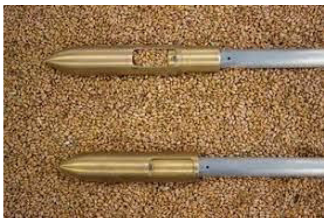
Figura 9. Detalles de los compartimentos de los cargadores de muestras de semillas, los cuales están conectados por una cadena o cuerda en el interior de un tubo, que permite su apertura y cierre a la profundidad deseada. FAO, 2019.
