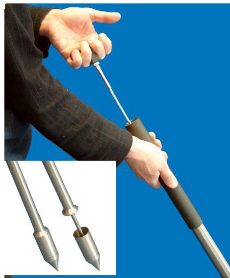
Figura 9. Detalles de los compartimentos de los cargadores de muestras de semillas, los cuales están conectados por una cadena o cuerda en el interior de un tubo, que permite su apertura y cierre a la profundidad deseada. FAO, 2019.
