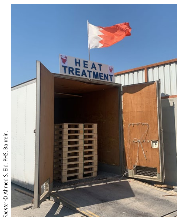
Cámara de tratamiento con calor conforme a la NIMF 15 en Bahrein
