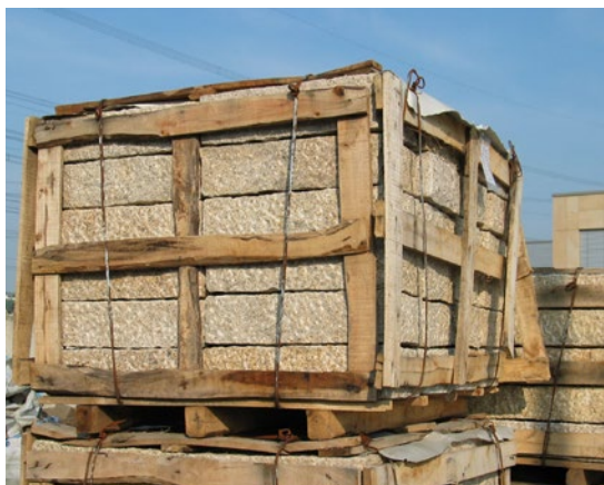
Jaula de madera que se utiliza para proteger piedras graníticas
