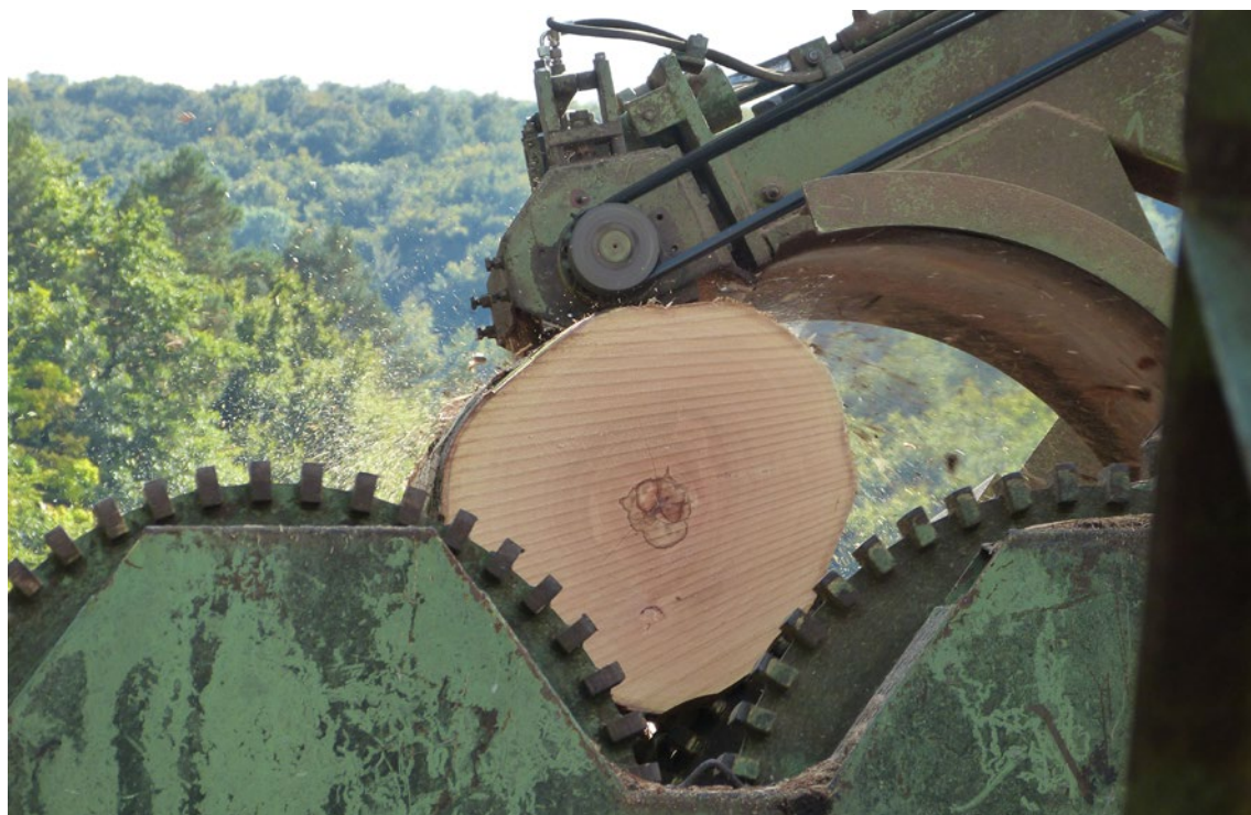
Figura 2. equipo descortezador para troncos de madera dura
